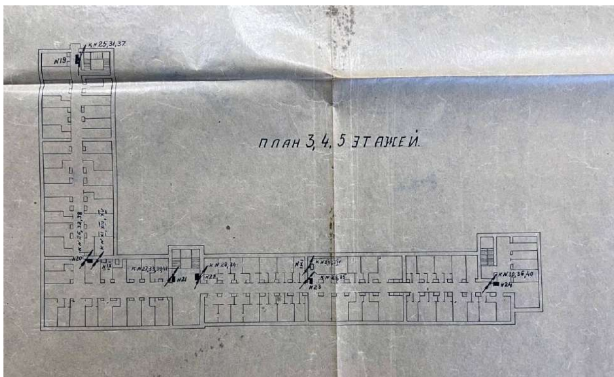
Рис. 49 а, б. Гостиница. Схема электросетей. Планы 2, 3, 4, 5 этажей. Проектная контора «Челябпроект». 1937. Источник: ОГАЧО. Ф. 318. Оп. 2 – 4. Д. 190
