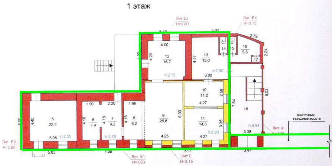
18. План 1-го этажа магазина – пивной лавки, кирпичных въездных ворот «Комплекса строений пивоваренного завода «Восточная Бавария» Якова Эрнста Зуккера» (Лит.Е, Е1, Е2, Е3) с выделением зелёным цветом исторической части здания, подлежащей сохранению/ Технический паспорт здания от 03.12.2007 г. № 12646.
