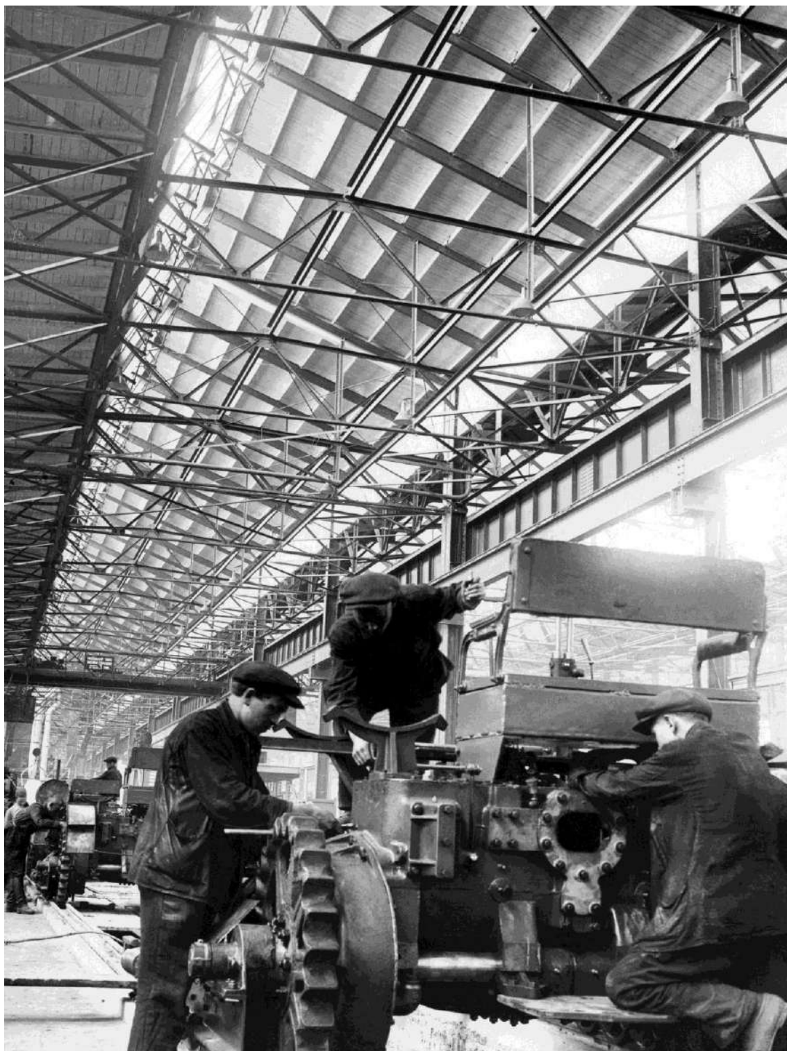
Рис. 7. Сборка трактора С-60 на конвейере ЧТЗ. Источник: ОГАЧО. Ф. Коллекция фотодокументов. Оп.1. Д. 2703. Л. 1.
